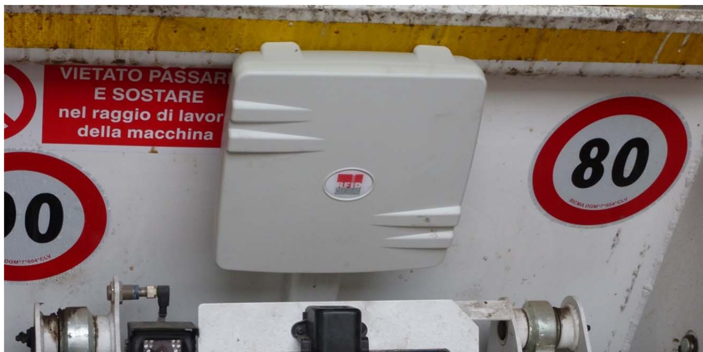
RFID UHF Antenna Industriale Rugged con Reader integrato, CPU, GPS e Sensori.
