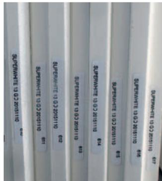
**Particolare dei tag Rfid sulle lastre finite di Stone Italiana**
