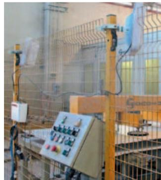
**Reader e antenne Rfid nell'impianto di inizio linea produzione presso lo stabilimento di Zimella di Stone Italiana**
