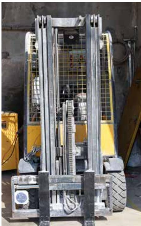
**Muletto smart LA.M. Plast con antenne RFID**
