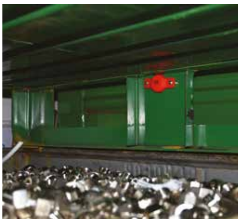
Beacon rivettato sul cassone nel magazzino di Italdadi by BluEpyc
