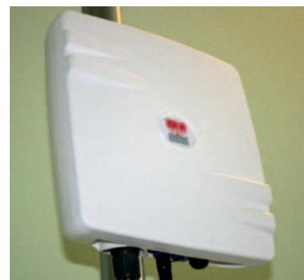
*RedWave Oberon 300 è il sistema RFID all-in-one, progettato e realizzato da RFID Global, che integra all'interno un reader RFID in banda UHF, un'antenna a polarizzazione circolare e una scheda elettronica*
