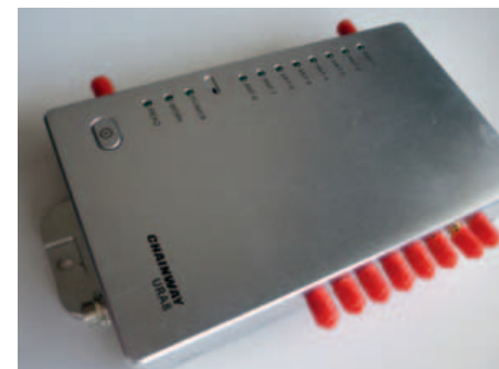
URA8 di Chainway è il reader RFID in banda UHF dotato di sistema operativo Android 9.0 e 8 canali d'antenna (multiplexer interno)
