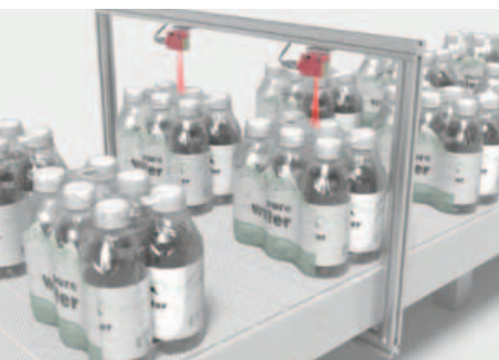
Il sensore per contenitori DRT25C.R di Leuze è installato sul nastro trasportatore che diventa il parametro per scegliere le altre superfici intercettate
