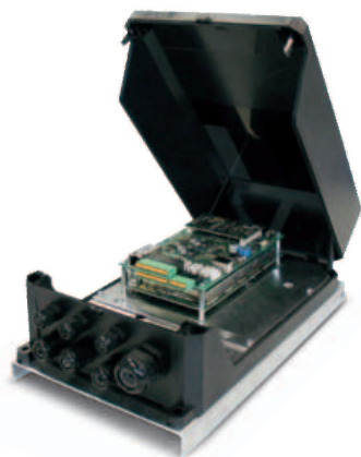
Il Controller RFID Long Range Reader LR2500 di Feig Electronic opera in banda HF per la lettura/scrittura di tag Iso 15693
