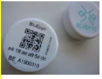
Il Disk Beacony di Global Tag permette di memorizzare a bordo fino a 1.000 valori di temperatura e altrettanti di umidità
