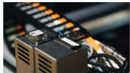
Il sensore SCD di Bosch Rexroth rileva il surriscaldamento o l'aumento delle vibrazioni e segnala i danni al motore
