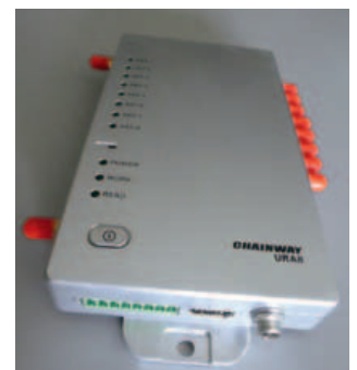
URA8 è il reader RFID in banda UHF di Chainway che poggia sul sistema operativo Android 9.0
