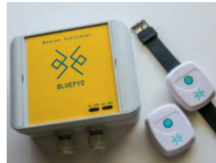
Il Beacon Wake-up si risveglia e trasmette il segnale in Bluetooth Low Energy all'EchoBeacon o al Gateway in ascolto
