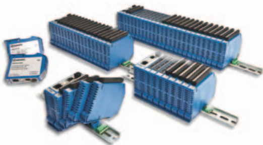
Il Maq20 è un sistema composto da moduli da guida Din, con connettori frontali, che si interfacciano con il modulo CPU attraverso apposito backplane
