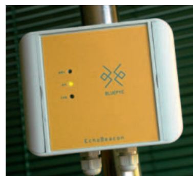
L'EchoBeacon è dotato di protezione IP 66 e 3 led di segnalazione, adatta le prestazioni alle esigenze applicative
