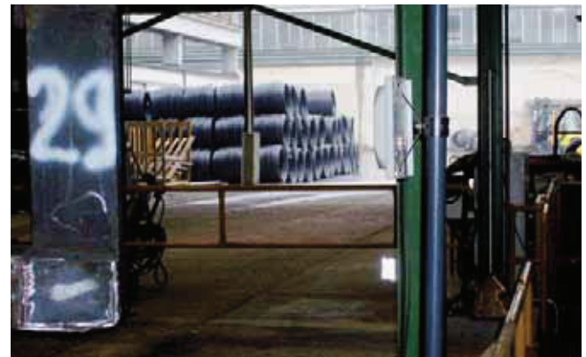
La soluzione impiega un mid-range reader MRU200, antenne 270x270 connesse ai reader, tag Rfid on metal apposti sulle bilancelle
