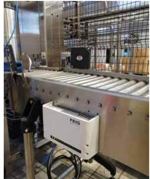
Il reader Rfid permette di rilevare il transito dei fusti sulla rulliera
