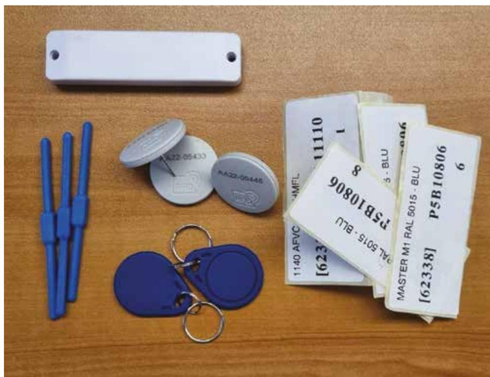
Dopo test e studi di fattibilità è stata utilizzata la tecnologia Rfid in banda UHF di Rfid Global, con tag dalle differenti configurazioni
