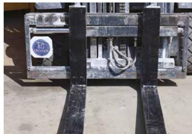
Le antenne Rfid installate sui muletti leggono o i tag che identificano la materia prima o i tag di posizione
