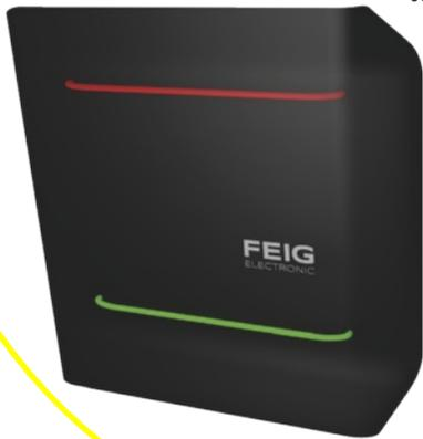
antenna a polarizzazione circolare, in grado di identificare transponder RFID in qualunque orientamento, LRU500i può connettersi anche a una seconda antenna per controllare un'altra area adiacente. Altro vantaggio: in fase di installazione dell'apparato, non è richiesto alcun cavo d'antenna, spesso oggetto di rotture, è sufficiente l'alimentazione elettrica e un cavo d'interfaccia (il modello PoE necessita del solo cavo di interfaccia).
