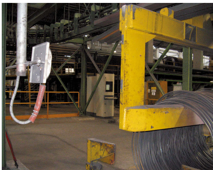
📍 Nell'acciaieria Ori Martin l'Rfid traccia in automatico la movimentazione dei rotoli d'acciaio a fine linea
