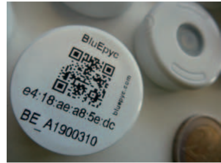
Il Beacon standard di BluEpyc supporta i sistemi operativi iOS e Android ed è compatibile con gli standard iBeacon ed Eddystone
