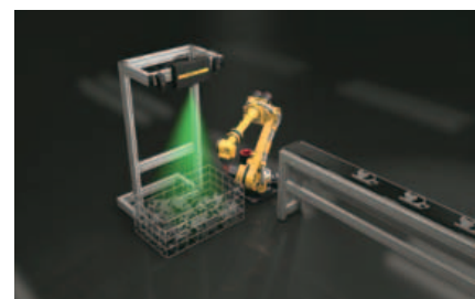
iRVision è il sistema di riconoscimento plug and play esiste in tre versioni, stesse funzionalità di base e supporta fino a 8 telecamere
