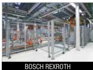
La flessibilità della produzione richiede dispositivi di sicurezza conformi agli standard, che possano essere installati e modificati in modo rapido, economico e flessibile: la nuova gamma EcoSafe tiene conto di questi requisiti complessi ed è compatibile non solo con la gamma precedente, ma anche con il sistema modulare di profili in alluminio Rexroth. Il nuovo componente di base è costituito da un sottile e stabile profilo in alluminio di 22,5x45 mm.
