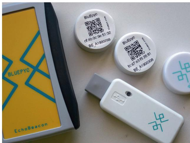
**BluEpyc ha sviluppato la soluzione Real Time Locating System basata sul 'Metodo delle Zone', il cui principio di funzionamento poggia su due componenti BLE: il gateway e l'EchoBeacon**
