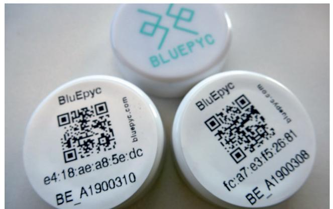
**Applicando i beacon a oggetti o persone in movimento e installando gli EchoBeacon o i gateway fissi nell'area da controllare si ottiene un sistema di identificazione, tracciabilità e di micro-localizzazione**
