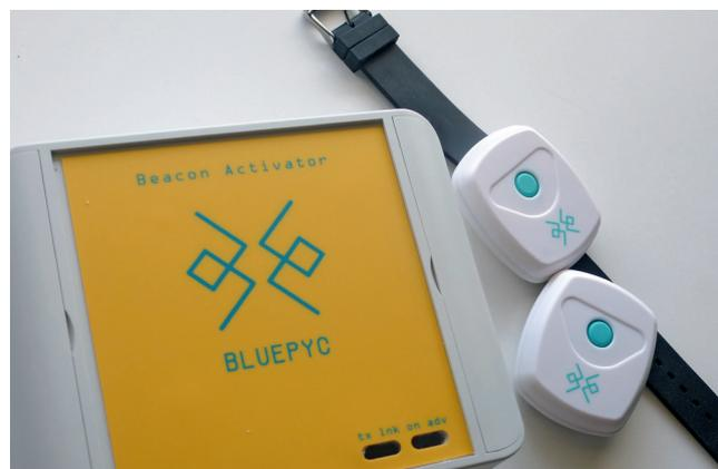
**Il sistema ibrido composto dal device Activator a onde radio per l'attivazione (risveglio) del beacon Wake-up consente di perfezionare la capacità di BLE nella localizzazione indoor di persone e asset**
