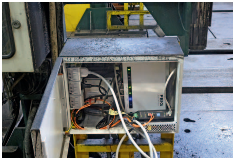
Le soluzioni Rfid Global, fra cui il dispositivo Rfid Long Range Reader LRU1002 di Feig, garantiscono una lettura corretta dei tag anche in ambienti ostici
