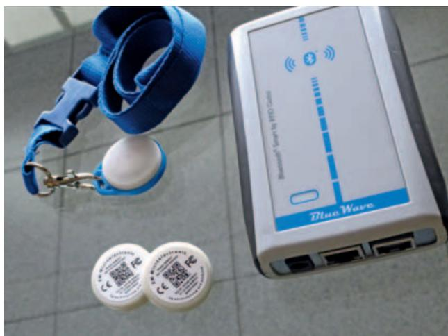
**I tag/Beacon trasmettono il segnale wireless a una distanza variabile in base alla potenza assegnata, arrivando fino a 50 m**
