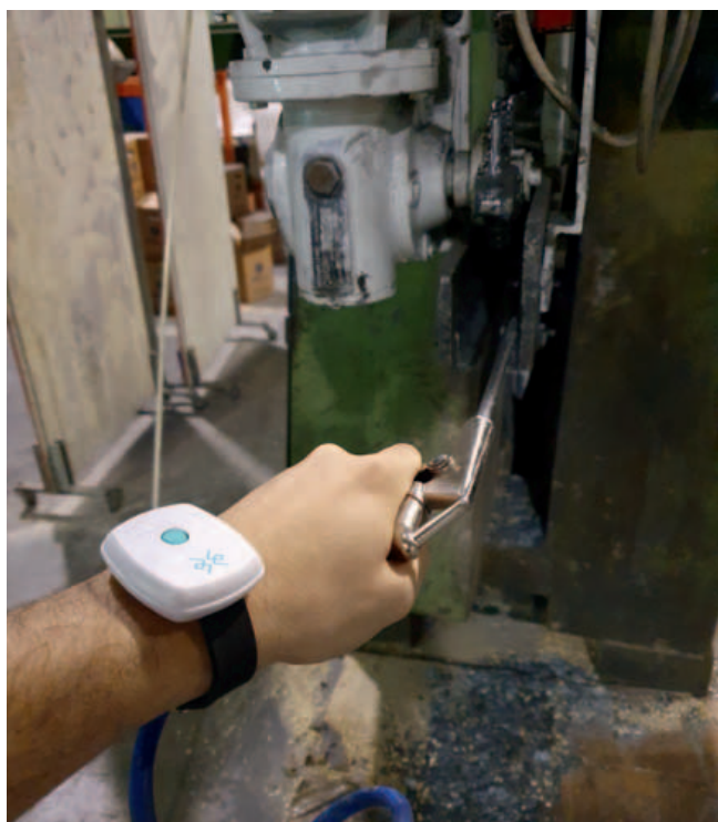
Assegnando il Beacon Wake-up all'operatore e installando l'Activator su ogni isola di produzione il sistema di BluEpyc raccoglie in automatico il dato di presenza
