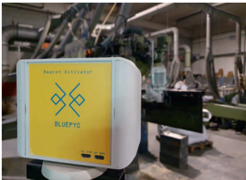
L'architettura Bluetooth LE è semplice, composta da un Beacon per ogni lavoratore e un Activator per ogni area/isola da monitorare
