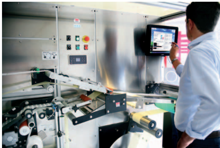
Tra i 'plus' distintivi del processo NFC figura l'accoppiamento automatico dell'etichetta cartacea della bottiglia di vino con il DNA Tag NFC, grazie all'Rfid Label Inserting Machine di Rfid Global
