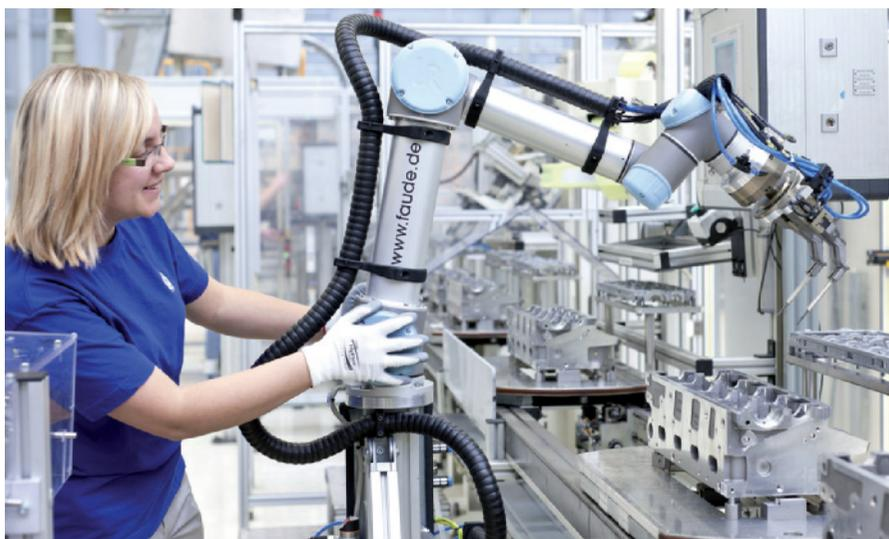
Un caso emblematico di RFID Embedded riguarda i Robot RFID-enabled, dove un reader integrato nell'end effector permette l'interazione anche con operatori umani, individuabili dal robot da un braccialetto con tag RFID.
