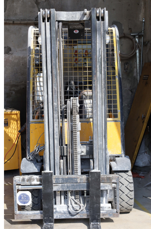
Sui muletti ci sono antenne RFID superiori e antenne montate sotto lo chassis.
