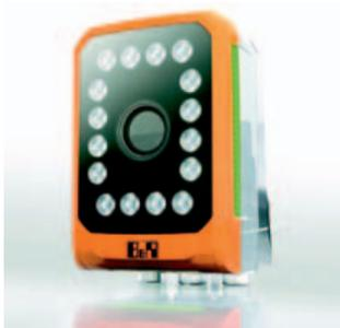
La soluzione di visione artificiale di B&R non necessita di un'infrastruttura dedicata, le camere comunicano direttamente in Ethernet Powerlink
