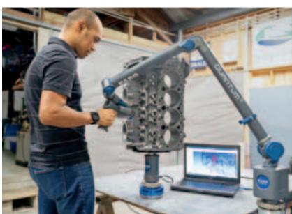
*Il Cam2 Quantum 8-Axis è soluzione portatile a otto assi ideale per le applicazioni di misurazione e scansione 3D senza contatto*
